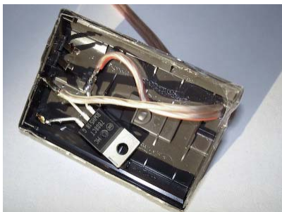
Links: geöffnetes Akkugehäuse mit eingebautem Spannungsregulator (s. Text weiter unten), Rechts: Kabelzuführung in das Akkufach der Kamera
