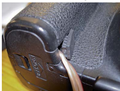
Links: geöffnetes Akkugehäuse mit eingebautem Spannungsregulator (s. Text weiter unten), Rechts: Kabelzuführung in das Akkufach der Kamera
