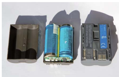
Links: geöffnetes Akku Gehäuse mit zwei Lithium Ionen Zellen, Rechts: geöffnetes Gehäuse und geschlossenes Gehäuse im Vergleich, an den langen Kontaktstreifen am linken Akkurand liegt die Nennspannung an.
