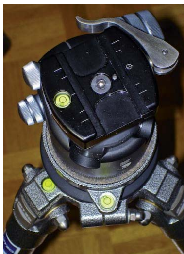
Links: Wasserwagen auf Stativ, Nivelliereinheit und Kugelkopf, Rechts: Nivelliereinheit Gitzo G1321 auf Stativ
